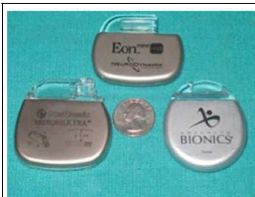
Fig. 1: Baterias implantáveis em modelos recarregáveis e não-recarregáveis.
